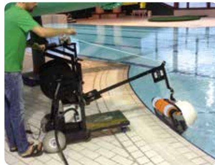
Si le rebord de la piscine possède une margelle, nous avons un chariot potence permettant d'extraire la machine sans effort.
