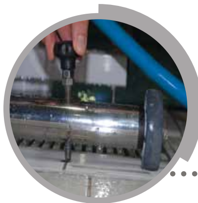
Molette de sécurité dans le sol, basculement impossible
