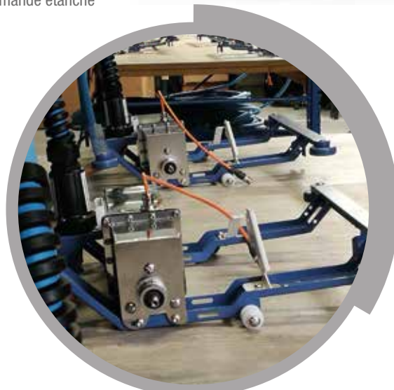
Châssis du robot ultra résistant et ultra léger en inox qualité marine, garantie anticorrosion
