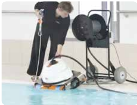
Le robot va tout seul à l'eau. Il possède une poignée centrale en inox pour le sortir très facilement du bassin.
